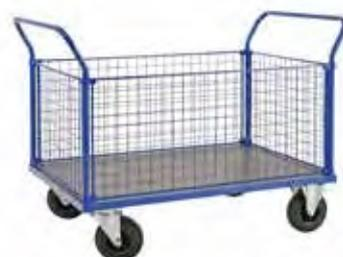
Peinture époxy et plateau MDF. Roulettes non marquantes. 1 étagères. Hauteur de la poignée: 1060 mm. Roues: 2 roulettes fixes 2 roulettes pivotantes avec freins. Diamètre des roulettes: 200 mm.
