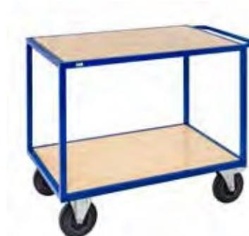
Peinture époxy et plateau MDF. Roulettes non marquantes. 2 étagères. Hauteur de la première étagère: 240 mm. Distance entre les étagères: 630 mm. Capacité par étagère: 600 kg. Roues: 2 roulettes fixes 2 roulettes pivotantes avec freins. Diamètre des roulettes: 200 mm.
