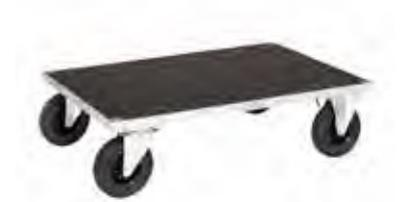
Electro-zingué avec panneau MDF. tube de 25 mm en acier. Roues: 2 roulettes fixes 2 roulettes pivotantes. Diamètre des roulettes: 200 mm.
